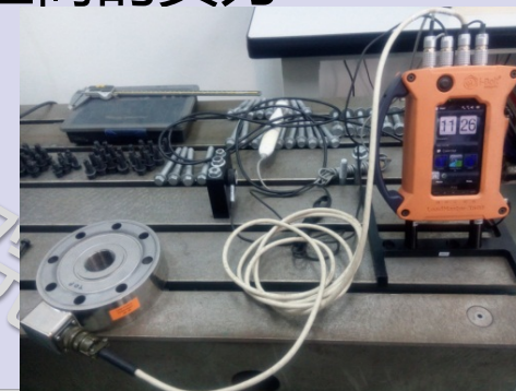
SCHATZ 螺纹紧固模拟装配试验分析系统
